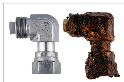
图 9: 经过 3,000 小时盐雾测试后的 ToughShield Plus (左) 和锌扣压 (右) 旋转过渡接头
